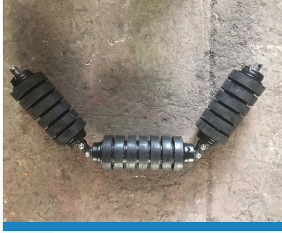
ASFALT KAZIMA MAKİNASI RULO GRUBU
